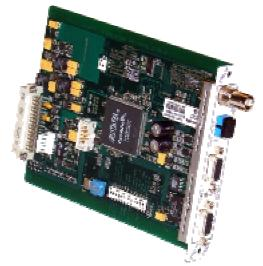
Les **ERC 1300** sont des équipements de transmission bidirectionnelle. Ils permettent de transmettre les signaux vidéo, audio, données et contacts sur une fibre optique.
